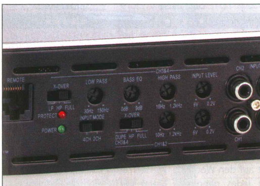
Kopierer: Der „Dupe“-Schalter überträgt die Einstellungen (Tiefpass und Bass-Boost) der Kanäle 3/4 auf das Kanalpaar 1/2.
