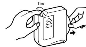
3. Tire de la palanca de disco en la dirección de la flecha y una parte del disco saldrá del cargador. Sostenga con cuidado el disco por el borde y extráigalo.
