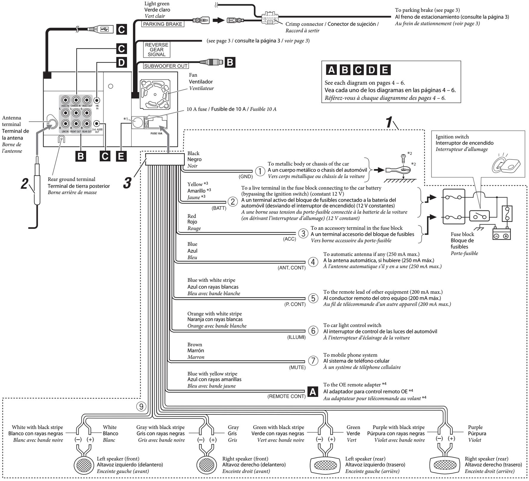
**A Connecting to the steering wheel remote controller / Conexión al control remoto del volante de dirección / Connexion de la télécommande de volant**
