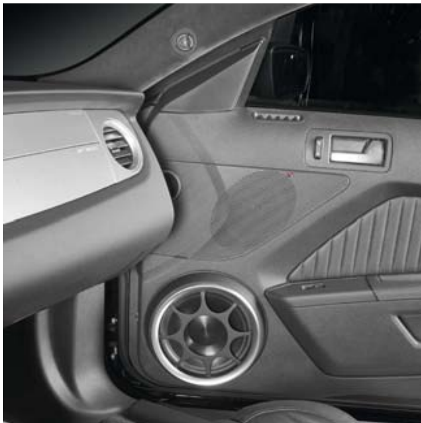
Установка пищалок в скошенной трубе несколько роднит конструкцию с незаслуженно забытыми излучателями Карлсона
