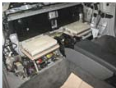
Усилители размещены на отдельных поста-ментах, под одним из них — штатный чейнджер
