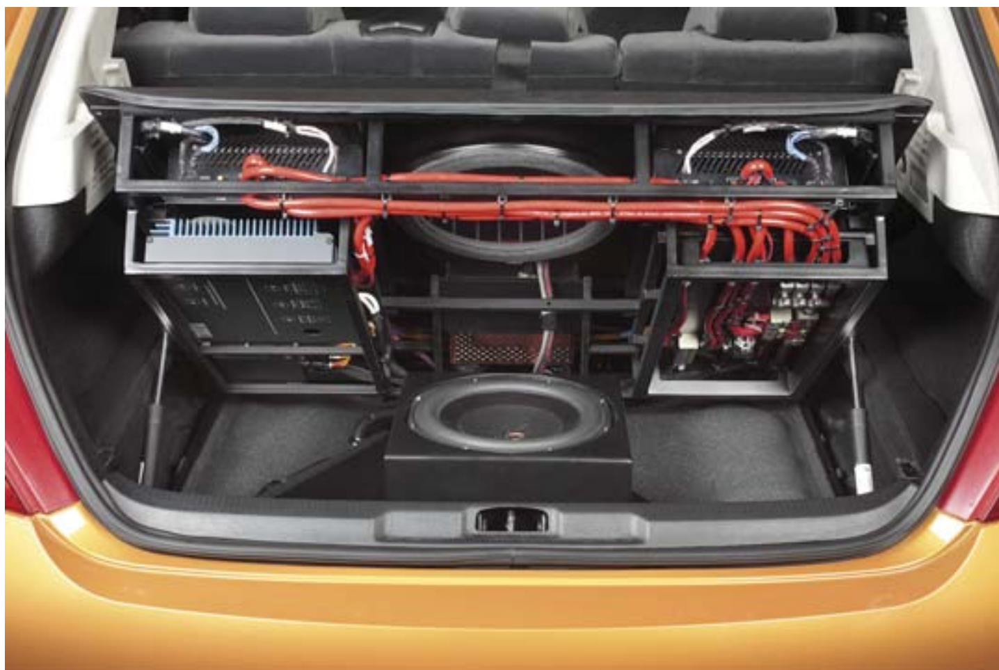
При подъёме рама как бы съезжает с «надстройки» сабвуферного корпуса
