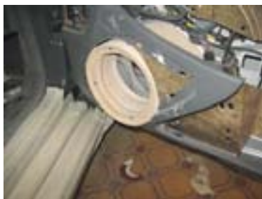
При снятых обивках видно: мидбасы не просто воткнули в штатные отверстия
