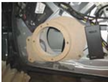
При снятых обивках видно: мидбасы не просто воткнули в штатные отверстия
