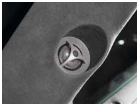
Установка пищалок в скошенной трубе несколько роднит конструкцию с незаслуженно забытыми излучателями Карлсона
