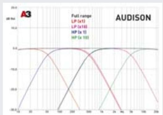
Нижний предел регулировки частоты среза у обоих фильтров чуть выше заявленного — 52 Гц вместо 50, простим? К тому же больше придаться не к чему: промежуточный (500 Гц) и верхний (5 кГц) пределы выдержаны аптекарски, а поддиапазоны состыкованы бесшовно. Крутизна фильтров (12 дБ/окт.) и добротность абсолютно неизменны.
