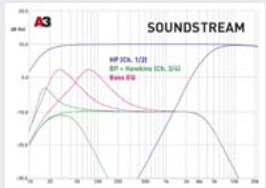
АЧХ вновь размечены по полю графика. В каналах 1 — 2 постоянно включён ФВЧ с пределами перестройки частоты среза 15 Гц — 4 кГц, строго как заявлено. В каналах 3 — 4 ФВЧ такой же, да не такой: при любой частоте среза регулятором Хоукинса можно менять добротность фильтра (в плюс), на АЧХ это выражается в регулируемом «подбросе» АЧХ вблизи частоты среза. Независимо от этого работает басовый эквалайзер с центральной частотой от 28 до 75 Гц по измерениям.
