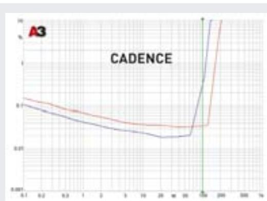
Зависимость искажений от выходной мощности — одна из типовых разновидностей «коленки», характерной для усилителей класса АВ. Мощность на 4 Ом — в соответствии с нашим техзаданием, при переходе на 2 Ом она возрастает на 45%. Больших резервов по току в усилителе нет, но и мало, скорее всего, не будет. Искажения достаточно низкие.
