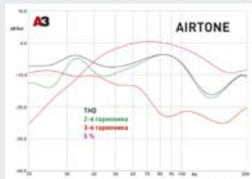
У длинноходовых головок — своя специфика: они хорошо «держат вес» на низких частотах (и больших амплитудах), но обладают признаками нелинейности на частотах более высоких. Впрочем, нелинейности в основном сводятся к несимметричной 2-й гармонике, это не так страшно.
