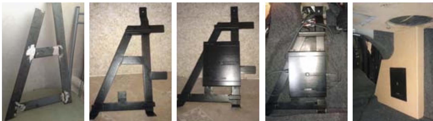
Изготовление и монтаж рамы процессора
