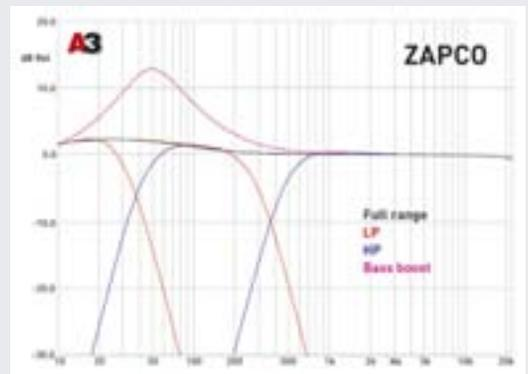
Второй участник с фильтрами 4-го порядка, пределы регулировки частоты среза — ровно как заявлено и размечено, несмотря даже на присутствие на АЧХ в полной полосе остатков бас-буста. Сам буст настроен на «американскую» частоту 50 Гц, на которой даёт подъём до ровно 12 дБ.
