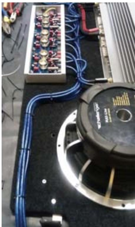
Межблочники впаяны в процессор напрямую, без разъёмов
