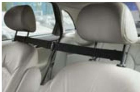
Штатное (по инструкции) положение микрофона LPM
