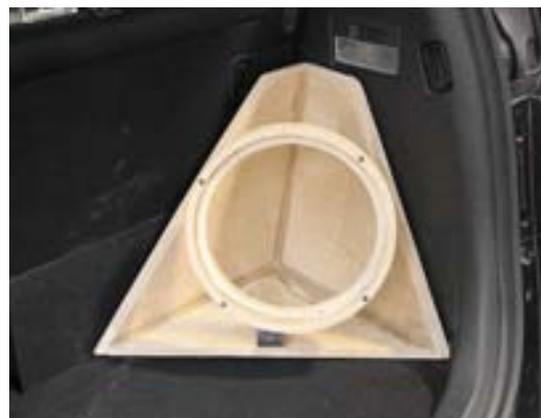
Каркас сабвуфера. Окончательную, слегка раздутую, форму ему придаст стеклопластиковая передняя стенка
