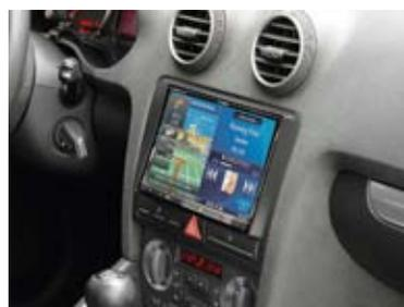
управления на руле, дублирование текстовой информации на бортовом MFD-дисплее, реализована совместимость со штатным усилителем. Выходы CAN-интерфейса обеспечивают вывод из шины данных автомобиля всех аналоговых сигналов, необходимых для функционирования головного устройства, включая сигнал импульсов скорости для точного ведения по маршруту в условиях GPS-тени (в тоннелях).
