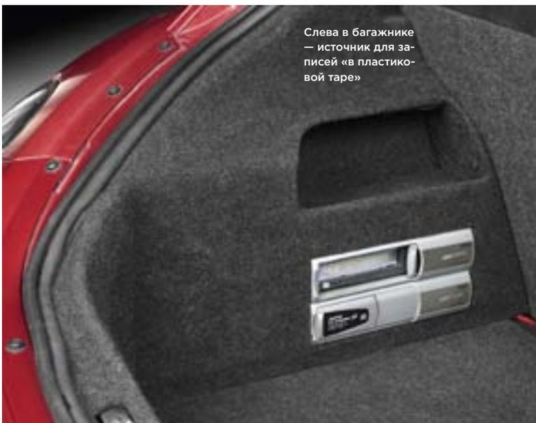
собраны в рядок под правой боковиной багажного отсека: входами и регулировками кверху, «силой» — книзу. Напротив, в левой боковине, друг над другом установлены два чейнджера. Облицовки облагородили, добавили светодиодную подсветку.
