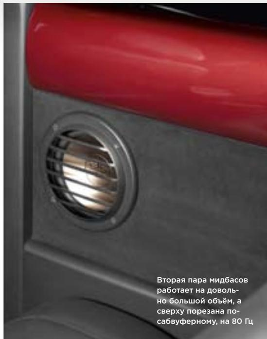
Вторая пара мидбасов работает на довольно большой объём, а сверху порезана по-субвуферному, на 80 Гц
