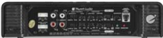
Обе пары каналов оснащены одинаково, в каналах 3 — 4 дополнительно есть бас-бустер и выносной регулятор уровня
