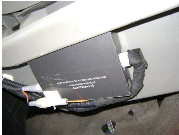
Предохранитель 1А на питание ГУ
