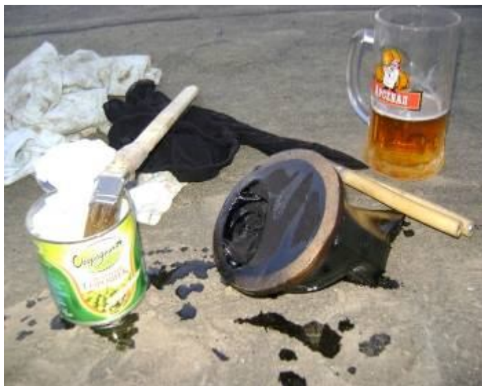
Выклейка эпоксидной смолой.
