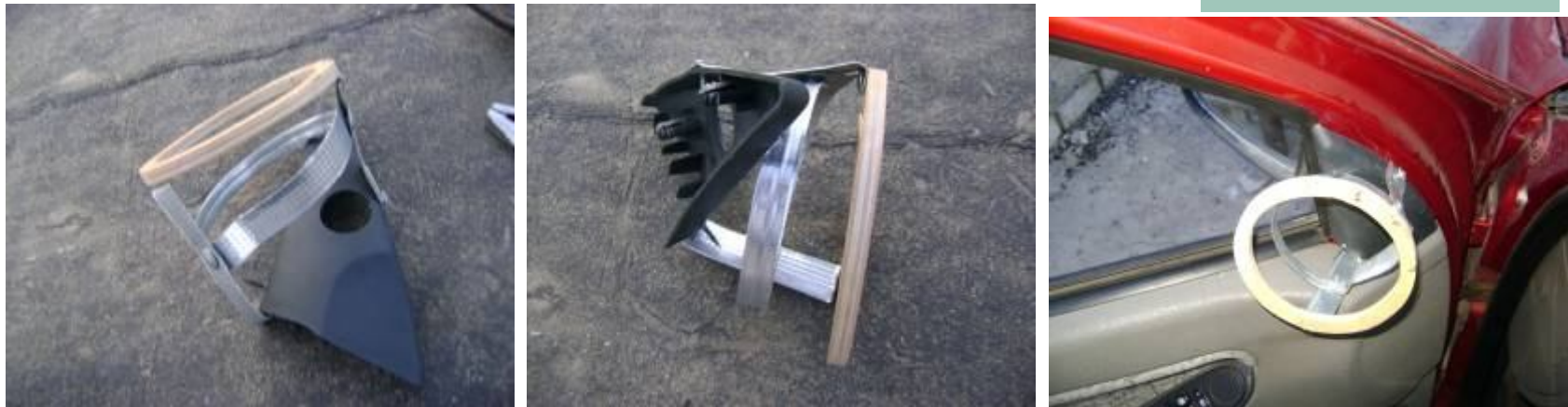
Выклейка эпоксидной смолой.
