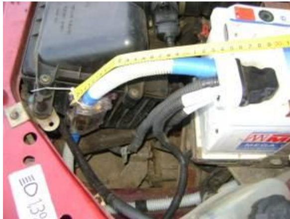
Предохранитель 1А на питание ГУ
