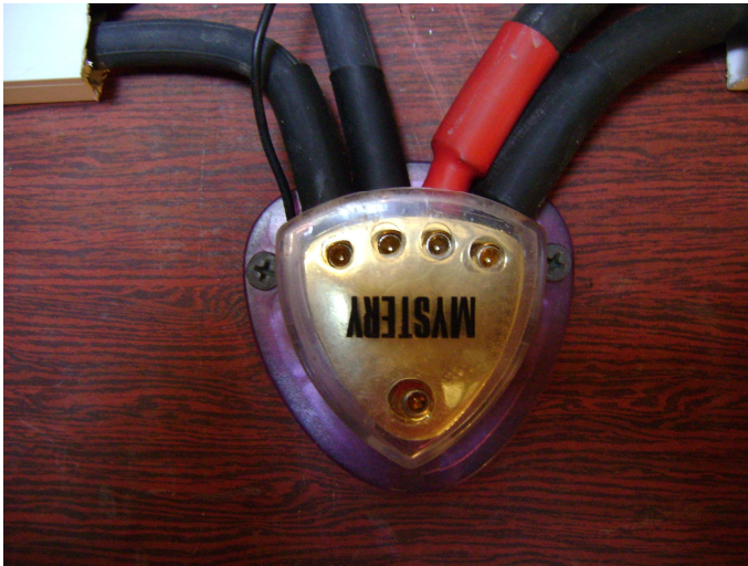
Заделка наконечника массового провода 9AWG на питание процессора
