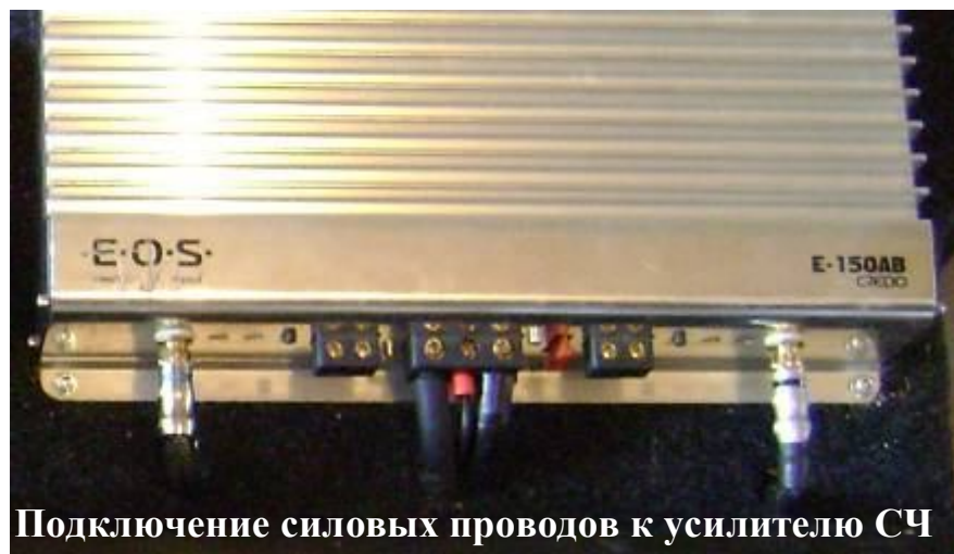
Подключение силовых проводов к усилителю ВЧ
