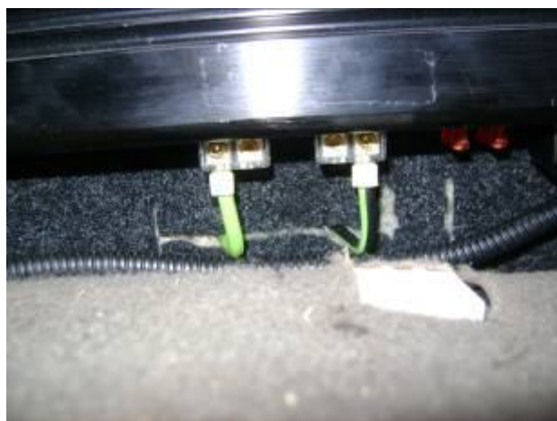
Подключение силовых проводов к усилителю НЧ
