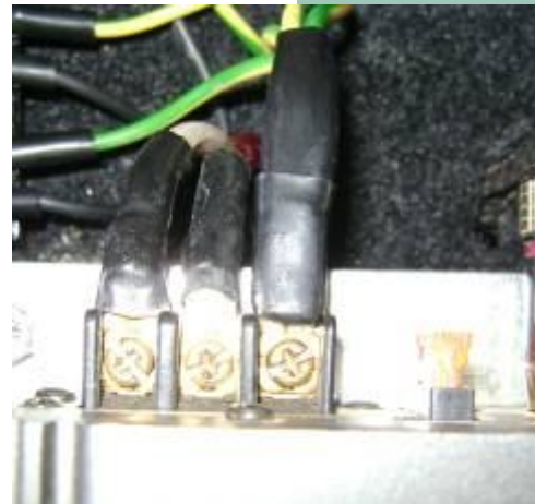
Провода REMOTE к флажковым предохранителям
