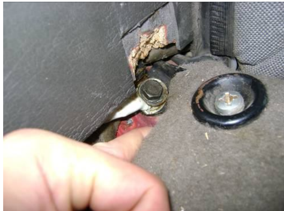
Заделка наконечника массового провода 9AWG на питание процессора
