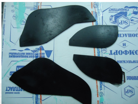
Жесткий материал, поглощающий вибрацию В данном случае фанера 10мм
