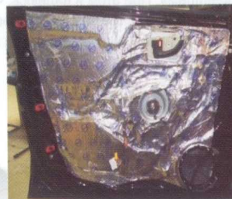
Стальная стенка на внутренней стороне двери. Ей полное демпфирование дает хороший эффект.
