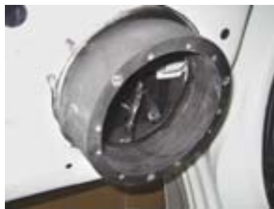
Установка мидбаса: опорный «колодец» из MDF, крепёжное металлическое кольцо, сделанные заново грили
