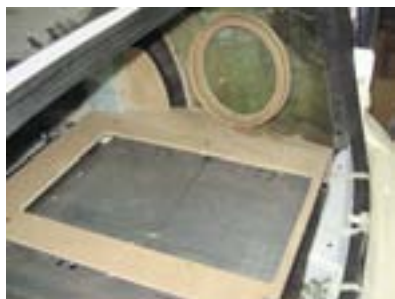
Сабвуфер основан на классической технологии «стелс»: плоские детали из MDF, объёмные — из стеклокомпозита
