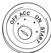
Замок зажигания, на котором предусмотрено положение ACC
