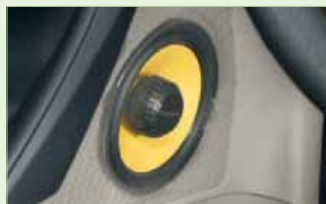
НЧ-динамик TS-Q131C после установки
