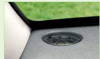
ВЧ-динамик TS-Q131C после установки
