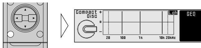
После заглавного экрана дисплей переходит к рабочему экрану меню эквалайзера (Equalizer Menu). При открытой или закрытой крышке пульта дистанционного управления (см. с. 4) дисплей меню и экран настроек переходит соответственно в открытое или закрытое состояние.
