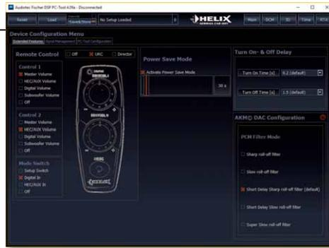
Im Konfigurationsmenü kommt beim DSP PRO MK2 eine Auswahl an Filtermodi des DAC-Chips hinzu
