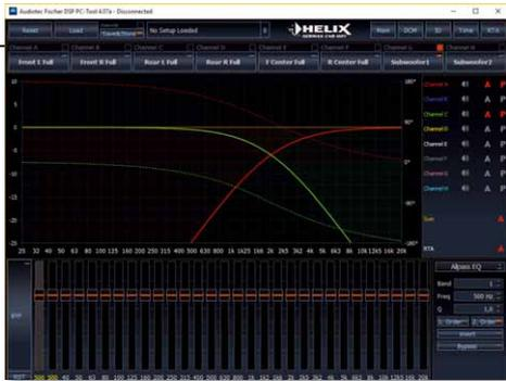
Bei der 4er-Software lässt sich das Frequenzgangfenster vergrößern, wahlweise auf Kosten der Weichen oder des EQs. Zusätzlich zur Amplitude kann die Phase angezeigt werden. Hier sind 12-dB-Linkwitzfilter zu sehen und die glatte Summierung
