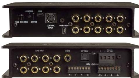
8 Eingänge, 10 Ausgänge, zweimal Digital-In bietet der MK2. Bei unserem Exemplar ist zudem das HEC HD-AUDIO USB-Interface montiert
