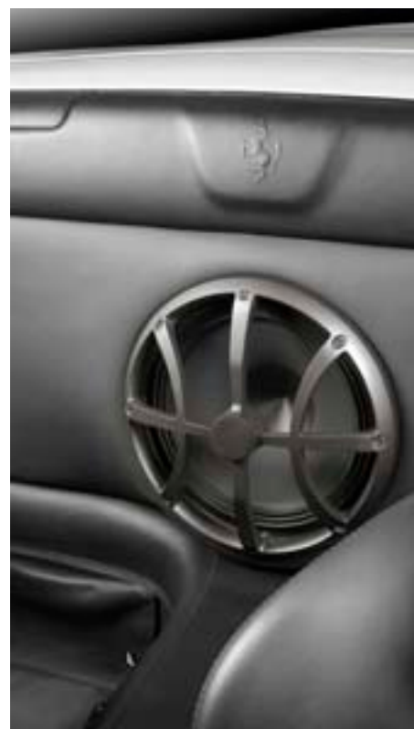
Между усилителем и процессором (в багажнике) и решёткой (в салоне) находится корпус сабвуфера довольно необычной формы
