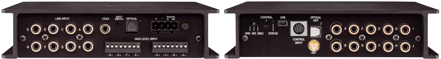
8-Kanal-Eingang und 10-Kanal Ausgang markieren den Stand der Dinge. Zusätzlich zur Basisversion lässt sich der Helix wahlweise mit Bluetooth-Audio-Streaming (Abb. rechts), analogem Klinkeneingang nebst Digitalausgang oder optischem Digitaleingang nachrüsten
