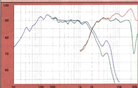
Die Chassis zeigen perfekte Frequenzgänge und symmetrische Filterflanken. Der große Hochtöner schafft eine beachtliche obere Eckfrequenz und der Tieftöner sogar 90 dB Schalldruck
