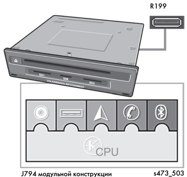
J794 модульной конструкции
