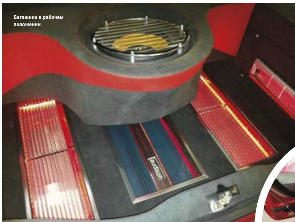
Поднятая панель со стеклом открывает доступ к усилителям
