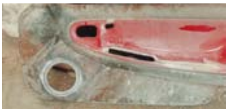
Новые обивки, полностью из стеклопластика, выклеены по матрицам, а матрицы сняты со штатных
