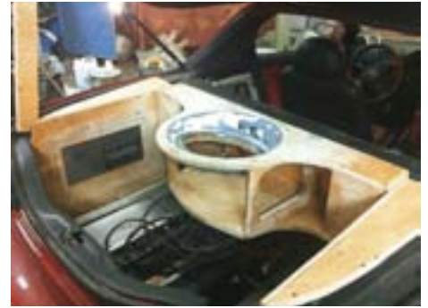
Силовая основа корпуса тылового сабвуфера
