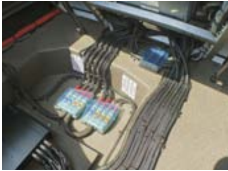
Часть компонентов заняла освободившуюся после замены колёс нишу запаски
