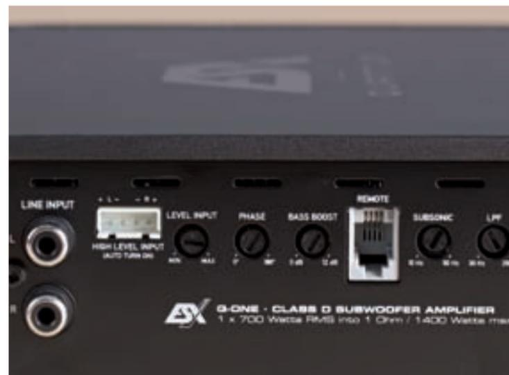
All inclusive: Der ESX-Bassverstärker Q-ONE hat für den Subwoofer ein justierbares Subsonicfilter und einen stufenlosen Phasenregler an Bord.
