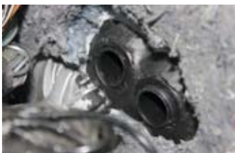
Не думали конструкторы, что через моторный щит такой машины понадобится протаскивать провода такого сечения
