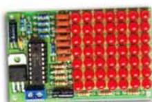
«Автомат световых эффектов на микроконтроллере».
