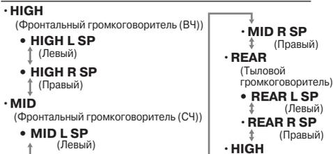
3-3. Нажимая клавишу [P.CH] в верхнем или нижнем направлении, отрегулируйте параметры «HIGH L SP», «HIGH R SP», «MID L SP», «MID R SP», «REAR L SP» и «REAR R SP».
