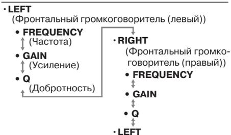
3-4. Нажимая клавишу [P.CH] в верхнем или нижнем направлении, выберите нужное значение частоты, добротности и усиления.
