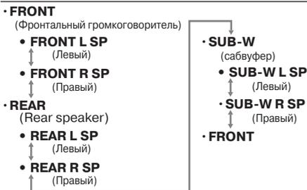
3-3. Нажимая клавишу [P.CH] в верхнем или нижнем направлении, отрегулируйте параметры «HIGH L SP», «HIGH R SP», «MID L SP», «MID R SP», «REAR L SP», «REAR R SP», «FRONT L SP» и «FRONT R SP».
