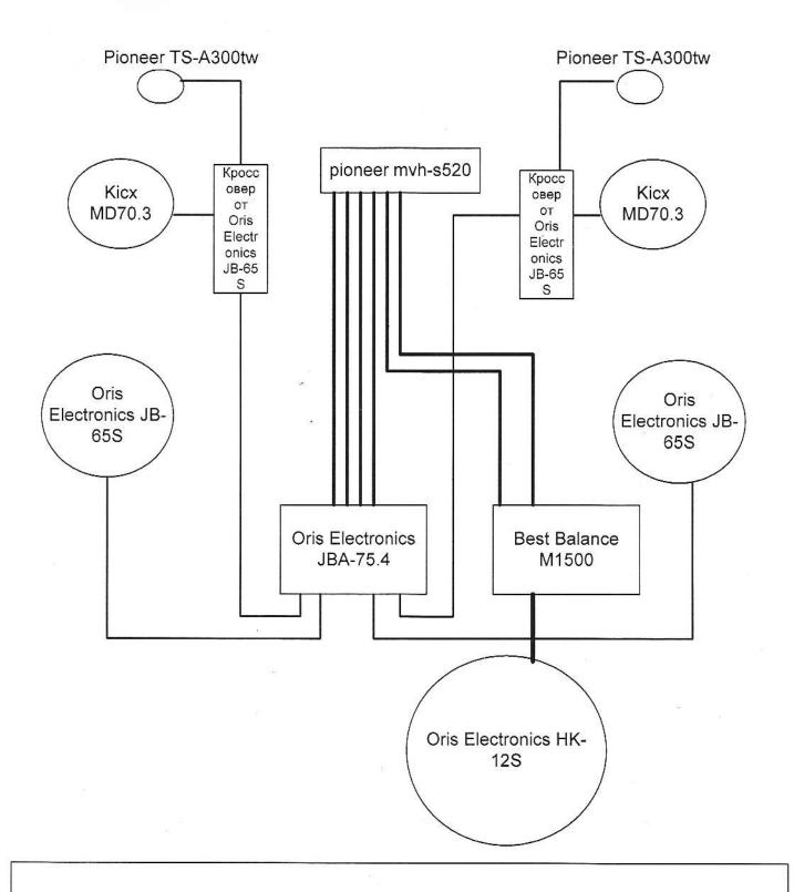
Пионер дает минимальную частоту на твитер и среднечастотник 1250 Гц. Хотя Кісхы могут играть спокойно от 500 Гц. Но зато в таком подключении можно с магнитолы немного регулировать отдельно громкость Твитера и СЧ и выставлять отдельно задержки на них.
