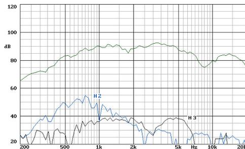
Nota: respuesta en frecuencia del tweeter en el eje medida en cámara anecoica, aplicando 1w@1m.
